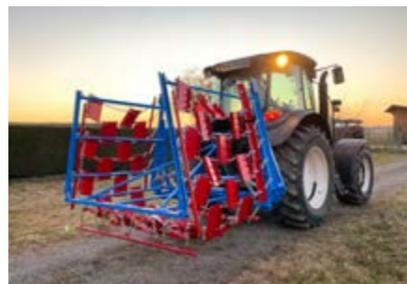
**TRANSPORTSTELLUNG** / das manuelle bzw. hydraulische System ermöglicht ein schnelles und einfaches Heben und Senken der äußeren Seitenteile der Wiesenegge, wodurch ihr Transport einfacher abläuft
