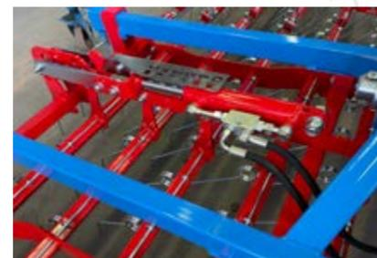
**NEIGUNGSEINSTELLUNG DER FEDERZINKEN** / Schnelle und einfache Einstellung des Neigungswinkels (als Option: **hydraulisch\***)
