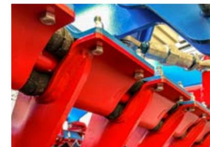
**SCHEIBEN AN GUMMIFEDERN** / gewährleisten eine gleichmäßige Bodenbearbeitung. Sie schützen die Kreiselegge, den Rahmen und den
