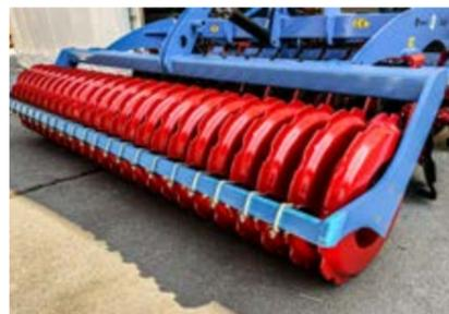
**SCHEIBENWALZE** / für Zerkleinerung von Klumpen in einer schwereren Erde bestimmt und für felsigen Boden geeignet. Ihr hohes Gewicht bietet eine hervorragende Leistung für alle Arten von Gelände, trockene und nasse Böden
