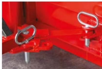
**MANUELLES DREHEN** / mithilfe eines einfachen Mechanismus kann der Pflugwinkel manuell eingestellt werden. Auswahl des Neigungswinkels zwischen 23 und 35 Grad
