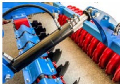
**HYDRAULISCHES TIEFENEINSTELLUNGSSYSTEM** / ermöglicht eine einfache, mittels mitgelieferter Abstandshalter fixierbare, stufenlose Anbautiefeneinstellung
