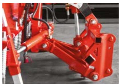
**HIDRAVLICNI CILINDER ZA DVIG** / Der Mechanismus ermöglicht die Queranpassung des Pfluges. / Der Einweg zylinder ermöglicht die Schwimmstellung des Pfluges. / Der kurz mechanismus gewährleistet die Wendigkeit und Stabilität des Traktors
