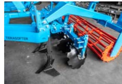
**VIER PAARE ZINKENSCHLEIBEN** hinter den Zinken vermischen die Pflanzenabfälle und Erde besonders gründlich. Bei einer zusätzlichen Düngung wird der Dünger effektiv in den Boden eingemischt. Eine getrennte Verstellung der Walzen von der Bearbeitungstiefeneinstellung ermöglicht noch optimalere Betriebsparameter.
