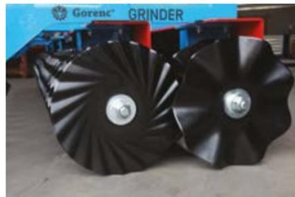
**TURBO-SCHEIBEN** / dank ihrer festeren Konstruktion schneiden sie aggressiver in die Anbaufläche / sie bearbeiten effizient auch anspruchsvollere Bodenarten / maximale Leistungsfähigkeit erreichen sie in Kombination mit den Wellscheiben
