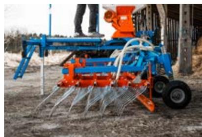
**NACHLAUFWALZE** / bestimmt für die Ebnung von Maulwurfshügeln und unebenen Flächen. / Er wird auf Grasflächen verwendet. / Die elastische Aufhängung sorgt für einen ständigen Kontakt zum Boden
