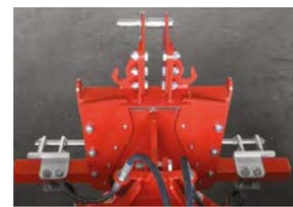
**3P - Dreipunktanschluss** / Ermöglicht einen 0N und Anschluss Kategorie I bzw. II an der Front- und Heckhydraulik / ermöglicht eine Queranpassung des Pfluges an das Gelände
