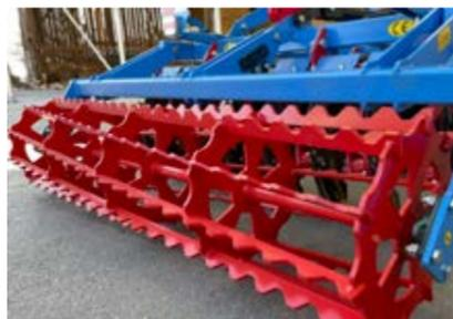
**STABWALZE** / für Zerkleinerung von Klumpen und Einebnung der Anbaufläche bestimmt. Für die Behandlung von trockenen und nassen Böden geeignet.
