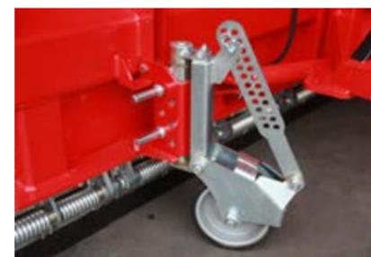
**STUTZRAD** / verschleißfester Hartgummi / in Fahrtrichtung flexibel / breite Lauffläche, damit der Abstand des Pfluges zum Boden im Betrieb konstant bleibt
