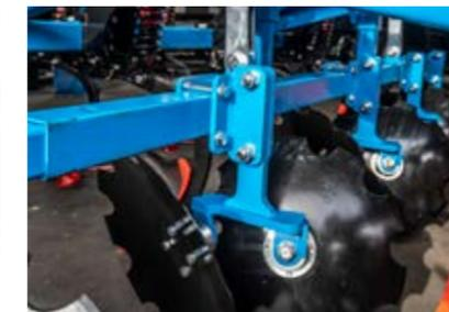
**Mischscheiben** werden je nach Art und Beschaffenheit des Bodens bzw. der Fahrgeschwindigkeit separat eingestellt. Dies ermöglicht ein maximales Mischen und eine flache Oberfläche.
