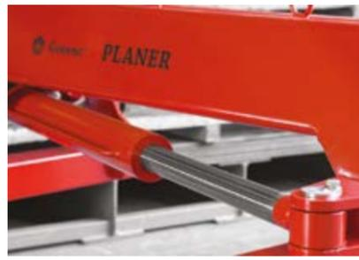
**HYDRAULISCHES DREHEN** / Ein starker Hydraulikzylinder ermöglicht eine automatische beliebige Winkleinstellung, die sich aufgrund der Zylinderkraft während der Schneeräumung nicht verändert
