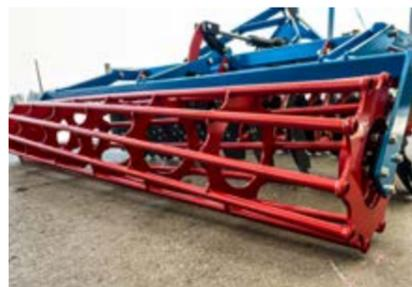
**ROHRWALZE** / für Zerkleinerung von kleineren Klumpen und Einebnung der Anbaufläche bestimmt. Ihre feste Bauweise ermöglicht, eine konstante Arbeitshöhe zu halten. Für die Behandlung von trockenen und nassen Böden geeignet
