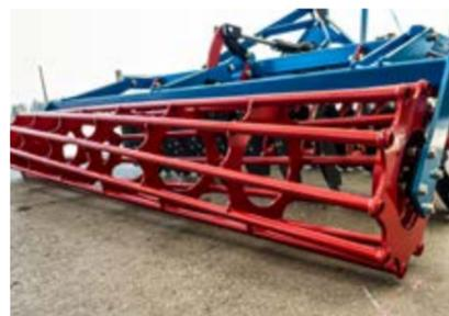
**ROHRWALZE** / ihre feste Bauweise ermöglicht konstante Arbeitshöhen in felsigen und nassen Böden. Für alle Bodenarten geeignet.
