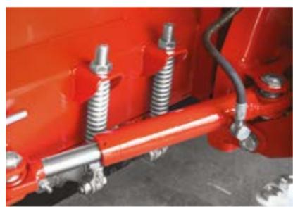
**HYDRAULISCHES DREHEN** / Einfaches hydraulisches Drehen in der Links- und Rechtsrichtung
