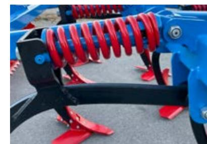
**FEDERSICHERUNG** / ermöglicht die Arbeit auf unterschiedlichen Böden. Egal ob steinig, lehmig oder sandig, die Böden bearbeiten Sie ohne Zinkenbruch- oder Ausfallrisiko.
