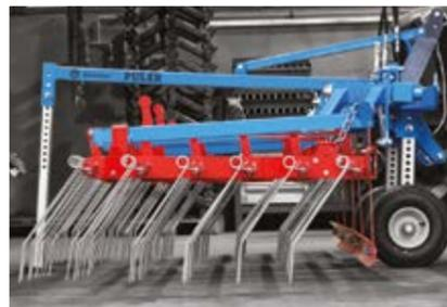
**REIHENFOLGE** / die hohe Effizienz der Egge gewährleistet die Komplementarität der einzelnen Elemente, die in der folgenden Reihenfolge angeordnet sind: Stützrad, Nachlaufwalze und 6 Reihen Federzinken
