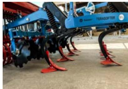
**STÜTZENKOMBINATION** in 2 oder 3 Reihen, 4 Scheibenpaare zum Einebnen und Mischen des Bodens und einer Walze am Heck ermöglichen eine erstklassige Bodenbehandlung nach der Ernte und Saatvorbereitung. Die Höhe der Maschine beträgt 850 mm, was bei einer maximalen Tiefe von 300 mm ein hochwertiges Mischen von Erde, möglichem Abfall und Schutt ermöglicht
