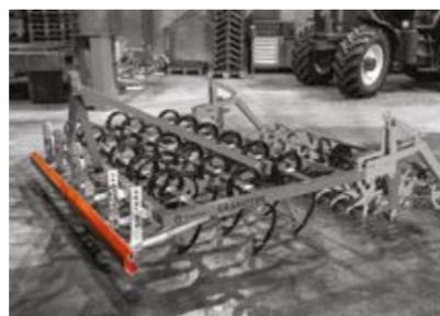
**NACHLAUFWALZE** / zum Ausgleich der Furchen über die gesamte Breite / höhenverstellbar / hervorragende Leistung durch elastische Aufhängung garantiert / für Montage an einer neuen oder gebrauchten Saatbettkombination geeignet
