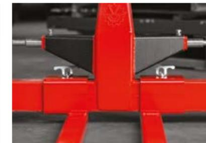
**TRANSFER SUPRA M** / Breitenverstellung ermöglichen / Gabelquerschnitt 100 x 50
