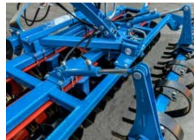
**ZYLINDEREINSTELLUNG** der ersten Zinkenreihe ermöglicht eine schnellere Anpassung von Ausgleichs-/Schneidezinken an der Maschine
