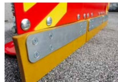
**VULKOLLANSCHAR** / Zur Verfügung steht eine Schar aus Vulkollan / hohe Beständigkeit gegen Beschädigungen / Eignet sich vor allem für die Schneeräumung und Reinigung von empfindlicheren Unterlagen
