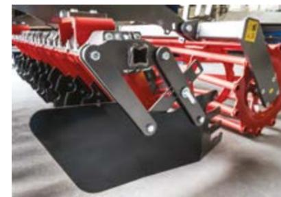
**SEITENPLATTE** / hält die Erde im Umfang des Anbaustreifens. Für eine maximale Wirkung ermöglicht sie unterschiedliche Positionseinstellungen.
