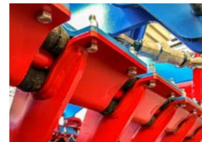
**SCHEIBEN AN GUMMIFEDERN** / gewährleisten eine noch gleichmäßigere Bodenbearbeitung. Die Federkraft vergrößert die Zerkleinerungsleistung und trägt gleichzeitig zum Komfort des Traktorfahrers bei.
