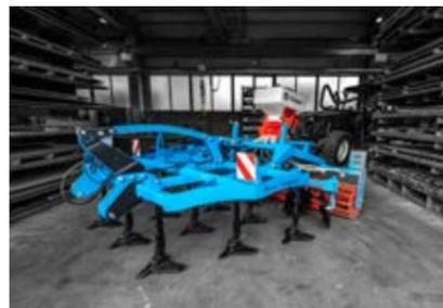
**STÜTZENKOMBINATION** / in 2 oder 3 Reihen, 4 Scheibenpaare zum Einebnen und Mischen des Bodens und eine Walze am Heck ermöglichen eine erstklassige Bodenbehandlung nach der Ernte und Saatvorbereitung. Die Höhe der Maschine beträgt 850 mm, was bei einer maximalen Tiefe von 300 mm ein hochwertiges Mischen von Erde, möglichem Abfall und Schutt ermöglicht. Kupplung Kategorie 2 u. 3.
