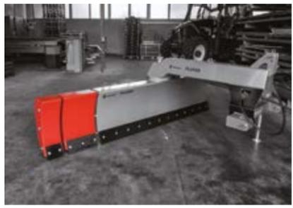
**VERLÄNGERUNG** / durch die einfache Montage der Verlängerung an der linken bzw. rechten Seite wird das Pflugbrett um 20 [26 kg] bzw. 40 cm [40 kg] verlängert
