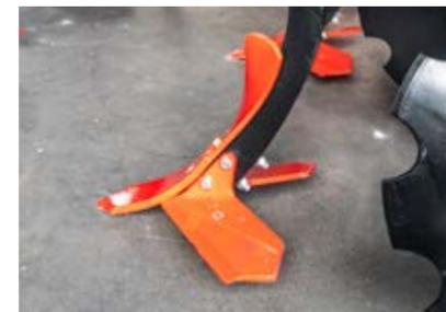
**ANGESCHRAUBTE MESSER** / Horizontalmesser für die Anbautiefen ab 200 mm separat ausbaubar. Die vertikalen Messer an den äußersten Stützen sind spiralförmig gebogen. Dadurch wird die Erdumdrehung auf die Arbeitsbreite der Maschine gerichtet.
