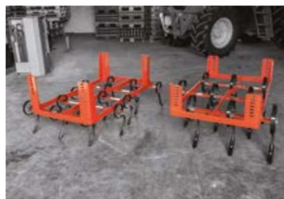
**3L-WECHSELEINHEIT** / ausgestattet mit Zinken 32 x 10, die eine hochwertige Bearbeitung des Ackerbodens für die Aussaat bis zu einer Tiefe von 15 cm ermöglichen
