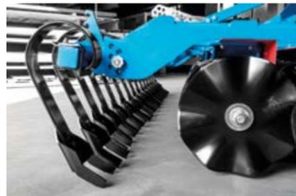
**AUSGLEICHSELEMENTE** / sie zeichnen sich durch das System der höhenverstellbaren Bearbeitungszinken aus, die bei Bedarf auch verstellt/geneigt werden dürfen (Option: hydraulisch)
