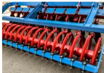
**V-TYP-WALZE** / für Zerkleinerung von Klumpen und Einebnung der Erde bestimmt. Für die Behandlung in nassen Böden geeignet
