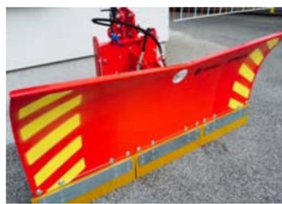
**PFLUGERHÖHUNGEN** / diese ermöglichen es, den Schnee weiter zur Seite/links bzw. rechts zu schieben
