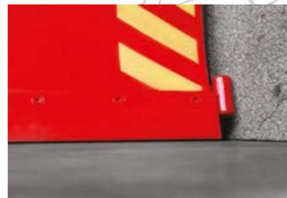
**PUFFER** / ermöglicht präzise Schneeräumung an den Rändern / verhindert Beschädigungen am Pflug und Randsteinen
