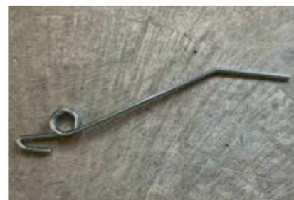
**FEDERZINKEN** / Länge 450 mm / Ø 6 mm für leichte Erde / Ø 7 mm universale Federzinken / Ø 8 mm für schwere Erde, steinigem Boden, Grünland
