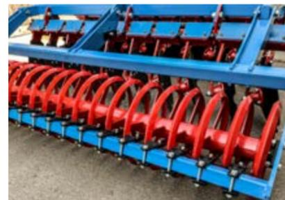
**V-TYP-WALZE** / für Zerkleinerung von Klumpen und Einebnung der Anbaufläche bestimmt. Für die Behandlung in nassen
