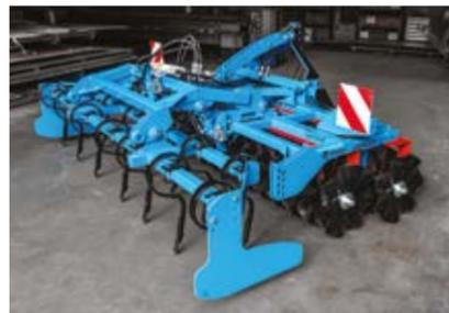
**2L - ZWEIREIHIGES SYSTEM** / es zeichnet sich durch zwei Arten von S-Zinken mit geraden Messern aus / wegen des starken Querschnitts gewährleistet es größere Kraft und Leistungsfähigkeit / geeignet für die Bearbeitung von anspruchsvolleren Böden / ermöglicht eine hydraulische Einstellung der Neigung und der Tiefe der Bearbeitung / bietet die Möglichkeit der Computersteuerung des Hydrauliksystems
