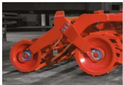
**ZERKLEINERUNGSWALZEN (GROSS/KLEIN)** / für die oberflächliche Zerkleinerung und Ebnung des Ackerbodens / spiralförmig verdrehte Leisten garantieren eine hervorragende Leistung und guten Bodenkontakt / bei einer hohen Umfangsgeschwindigkeit zerkleinern die Walzen effektiv die Klumpen / die Walzen halten während der gesamten Bearbeitung die verlangte Anbautiefe
