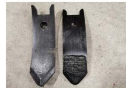
**HARDFACE-MESSER** / durch das angeschweißte, verschleißfeste Material wird die Behandlung von großen Flächen und abrasiven Böden ermöglicht.
