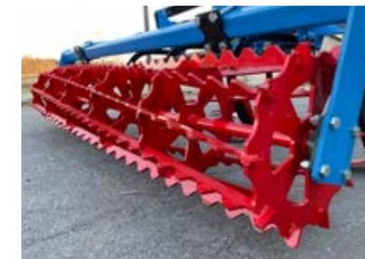
**STABWALZE** ist eine Zahnleiste, mit der die Klumpen zerkleinert und Unebenheiten ausgeglichen werden. Ihre feste Konstruktion ermöglicht die Bearbeitung von steinig, lehmigen und unkrautigen Böden. Mit der Walze können Sie die Anbautiefe stufenweise einstellen.
