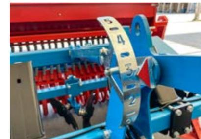
**Bearbeitungstiefeneinstellung** bis max. 30 cm stufenlos. Auf der großen, auch von der Traktorkabine aus sichtbaren Zahlenskala wird die Tiefenstufe angezeigt.
