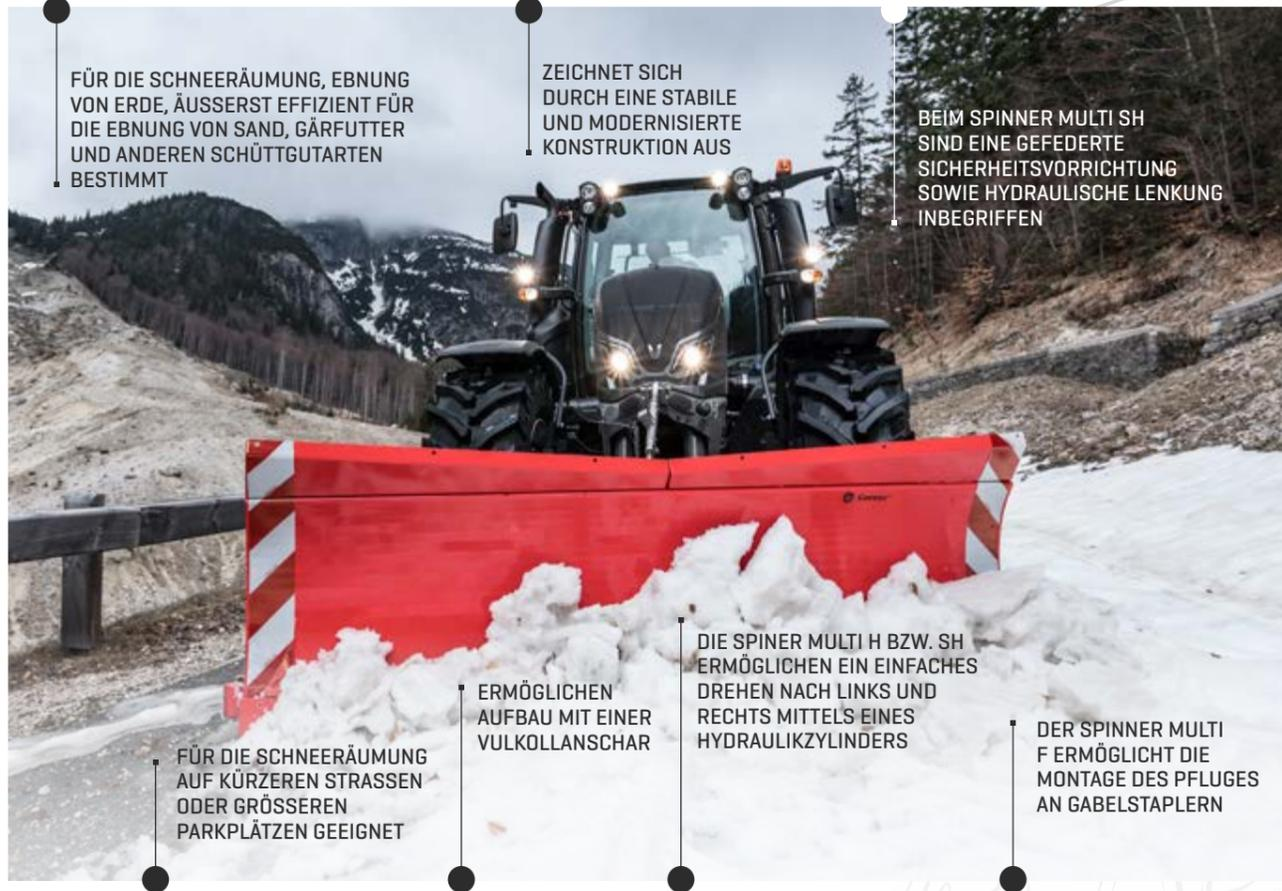
FÜR DIE SCHNEERÄUMUNG, EBNUNG VON ERDE, ÄUSSERST EFFIZIENT FÜR DIE EBNUNG VON SAND, GÄRFUTTER UND ANDEREN SCHÜTTGUTARTEN BESTIMMT
