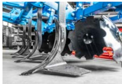
**VERTIKALKLINGE** und die geflügelte horizontale Form der Messer ermöglichen es, die Erdoberfläche effektiv zu öffnen und Pflanzenreste mit der Erde zu vermischen. Für alle Bodenarten geeignet.
