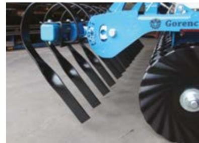
**SCHNEIDEZINKEN** / ermöglichen Höhenverstellung und Neigungsänderung. / dank ihrer stabilen Konstruktion sind sie für die Bearbeitung von schwereren Bodenarten geeignet. / ermöglichen Höhenverstellung und Neigungsänderung (Option: hydraulisch)
