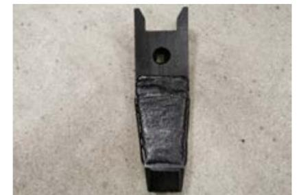
**DIAMANTMESSER** / mit seiner Spitze aus hochlegiertem Stahl und zusätzlich verschweißtem Material werden hohe Belastungen zugelassen und ist für Anwender mit großen Flächen und unterschiedlichen Bodenarten gedacht
