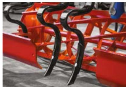
**SPURLOCKERER** / Höhenverstellbar. / Lockert und hebt den Ackerboden in der Spur hinter den Rädern
